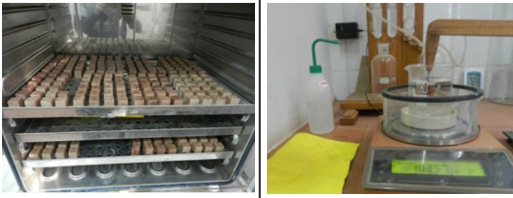
Figura 9. A. Obtención de peso seco mediante secado de muestras en estufa. B. Determinación de volumen verde de las muestras.
