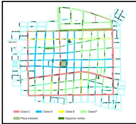
Figura 5: Clasificación de Vías de Tránsito según el tipo de actividad, Norma IRAM AADL, Barrio Centro de SDE. Fuente: Rigali y Raitelli (2008)
