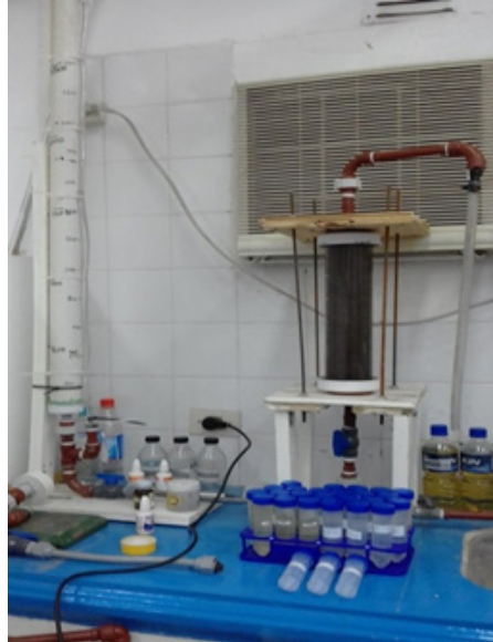
Figura 11. Equipo de laboratorio utilizado en los ensayos de lixiviación por percolación.
