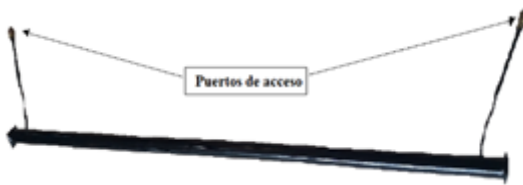
Figura 3. Foto del heat pipe en el que se muestran sus puertos de acceso rápido para la carga del fluido de trabajo.
