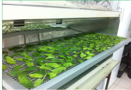
Figura 2. Imagen de la cámara de radiación UV-C (Equipo de radiación del CEPOC-UCI). Extraído de Gutiérrez (2015).
