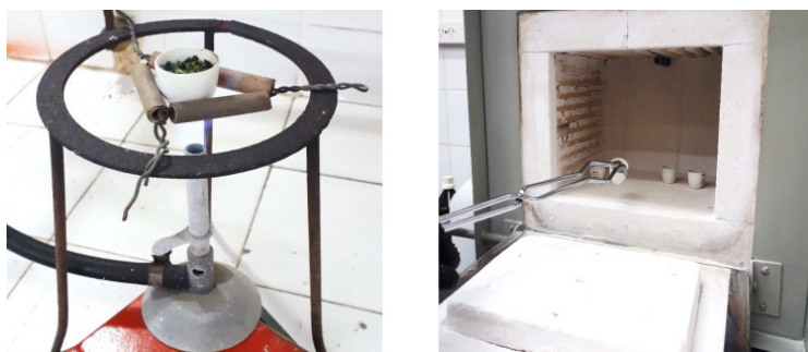
Figura 3. Preparación de la muestra. a)-carbonización y b)-calcinación.
